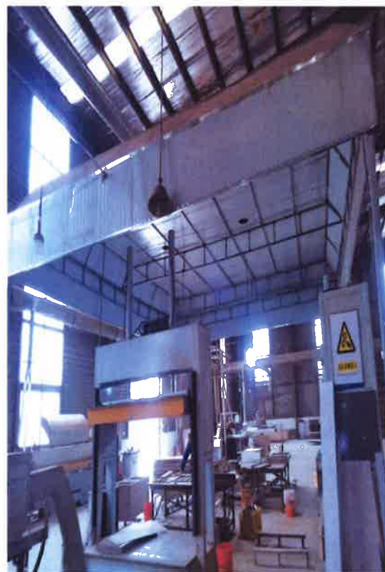
粘压、封边工序有机废气收集
