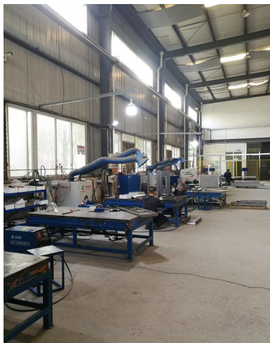
焊接烟尘净化器
